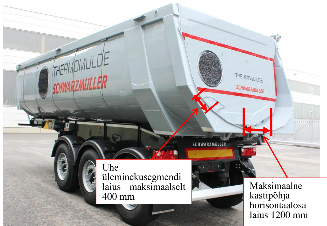
Joonis 1. Asfaltsegude transportiks mõeldud poolringi-kujulise ristlõikega termoisoleeritud veokikast.
