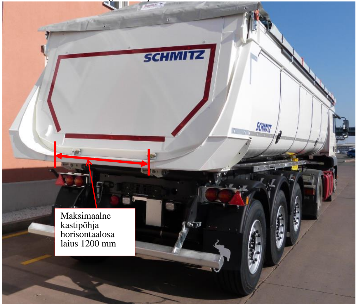
Joonis 3. Asfaltsegude transportiks mõeldud termoisoleeritud veokikast.
