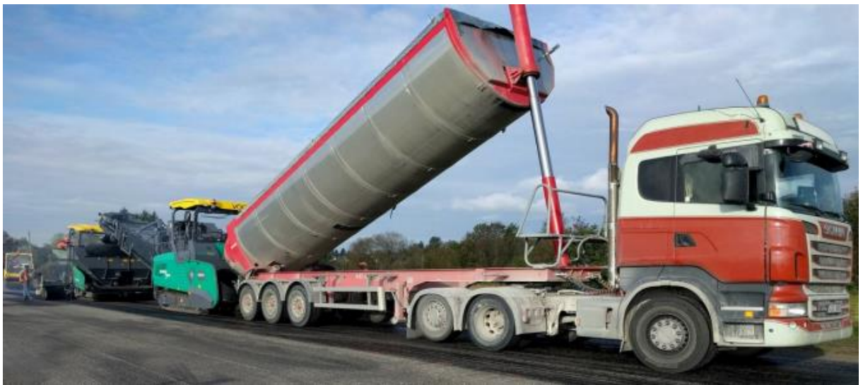
Joonis 1. Asfaltsegude transportiks mõeldud poolringi-kujulise ristlõikega termoisoleeritud veokikast.
