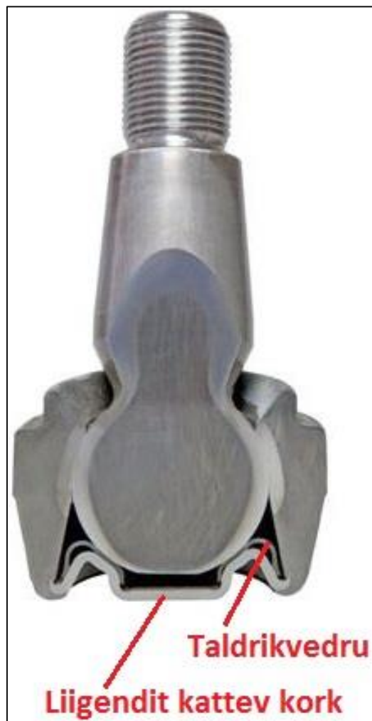
Joonis 1: uut tüüpi kuulliigendi osaline ristlõige (Foto: TRW XCAP)
