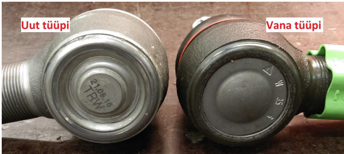
Foto 1: uut tüüpi ja vana tüüpi kuulliigendi korgi visuaalne võrdlus
