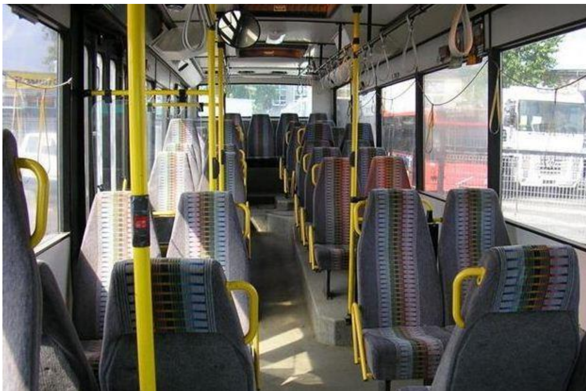
Joonis 3 - M3 kategooria sõiduk, I klass. Seisev reisija saab kinni haarata vähemalt kolmest kohast - käepidemest, käsipuust ja rihmast.
