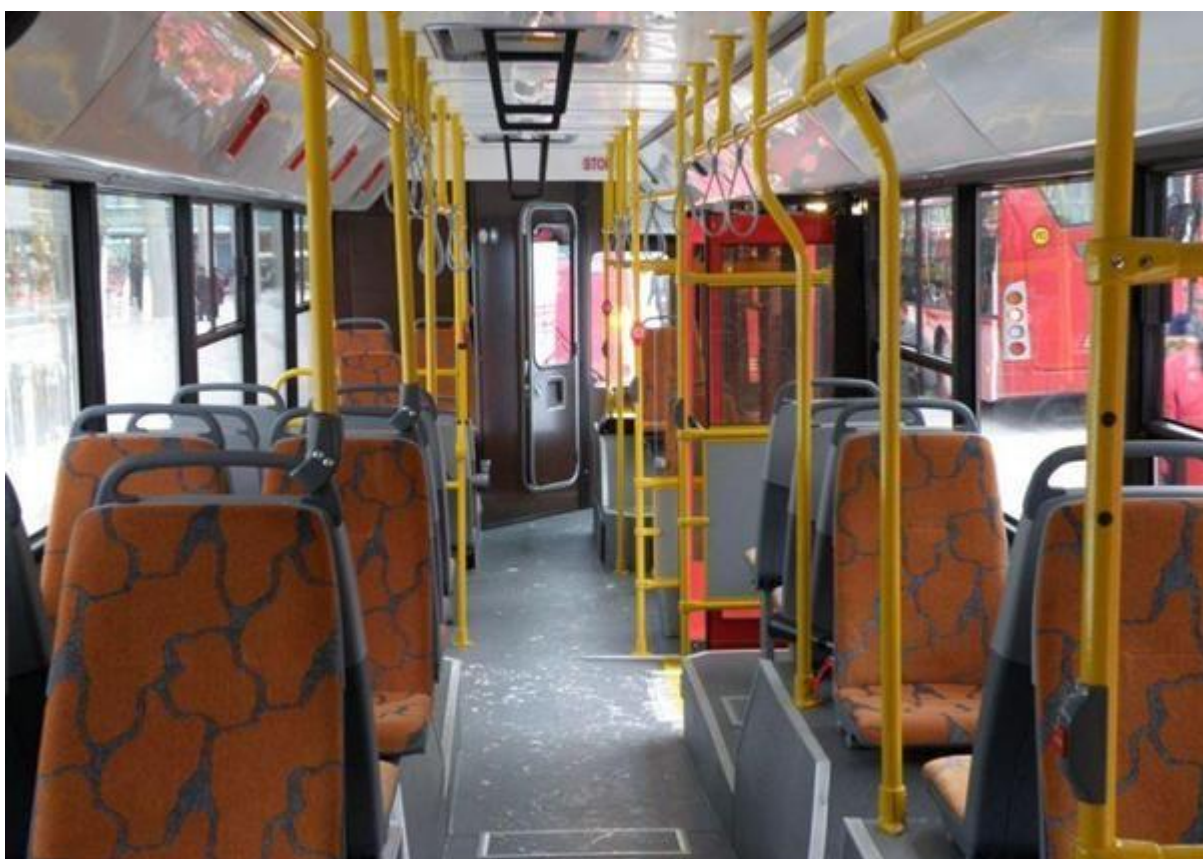
Joonis 4 - M3 kategooria sõiduk, I klass. Seisev reisija saab kinni haarata vähemalt kolmest kohast - käepidemest, käsipuust ja rihmast.
