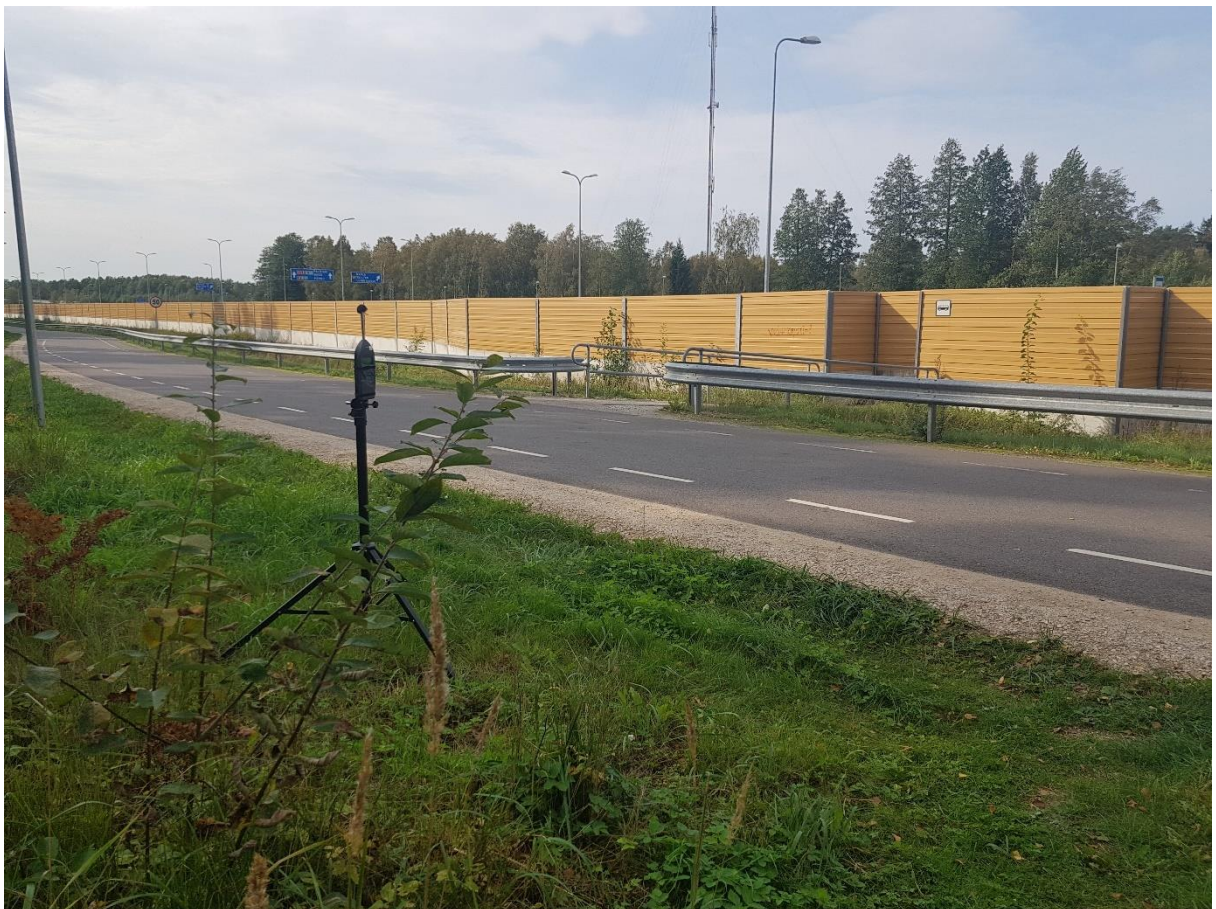
Joonis 1. Liikluse müra mõõtmine (ELLE OÜ)
