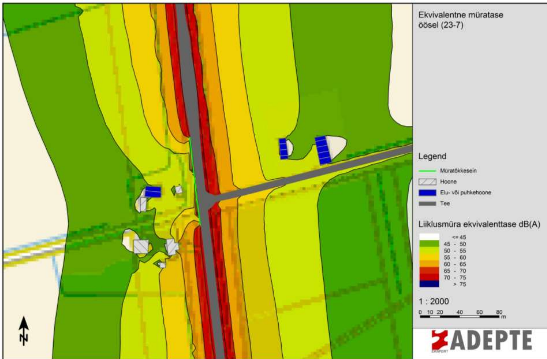
Joonis 7. Liikluse müra tase Risti kinnistul öösel perspektiivse liikluskõormusega aastal 2036 koos müratõkkeseinaga.
