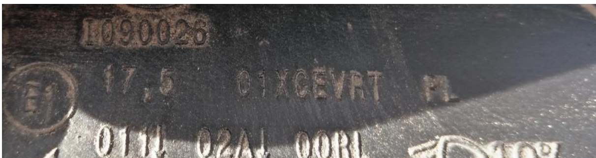
Pilt 5 - AFS-funktsiooniga esituli, milles kasutatakse gaaslahenduslampe
