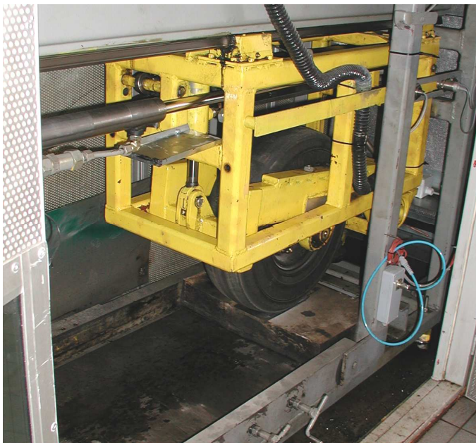
Pilt 4. Deformatsioonikatsel kasutatud rattaseade (Wheel-Tracking)
