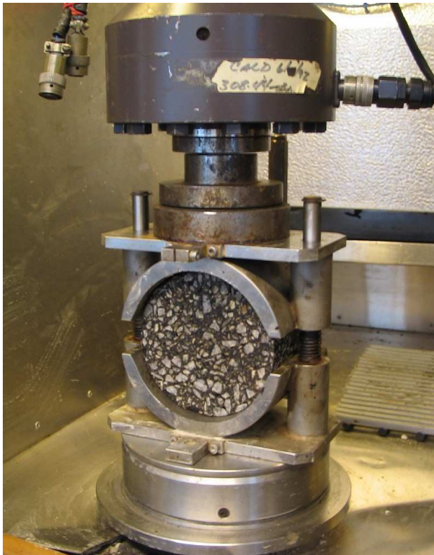
Pilt 3 – Marshalli katses ja külmakindluskatses kasutatud MTS-press (pilt tehtud Marshalli katse käigus)
