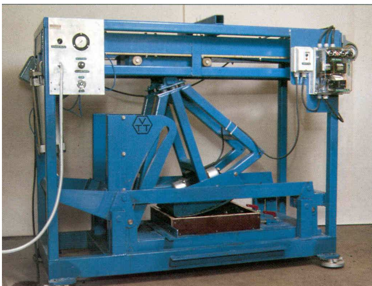
Pilt 2 – Proovikehade tihendamisel kasutatud pendelseade (kiikrull)
