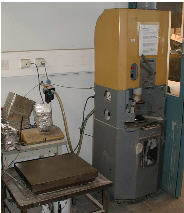
Pilt 1 – proovikehade valmistamisel kasutatud güraator (pöördtihendaja) ja kaalud
