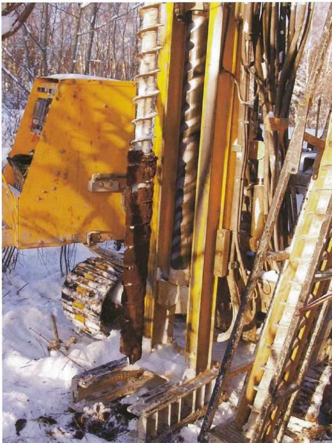
Foto 9. PA2 puurimine, puurvardal näha turbane muld.
