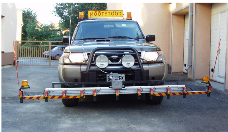
Pilt 1.1. Roopa sügavuse mõõtmise seade ROOBAS_ROADMASTER
